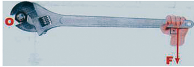
شکل (1-29) محکم کردن پیچ توسط رنج
