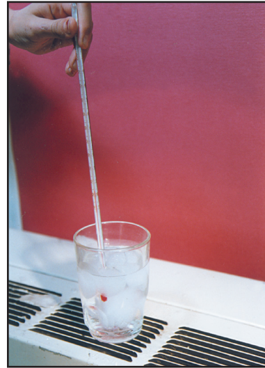
شکل (۱-۲۹) اندازه گیری نقطه ذوبان یخ
