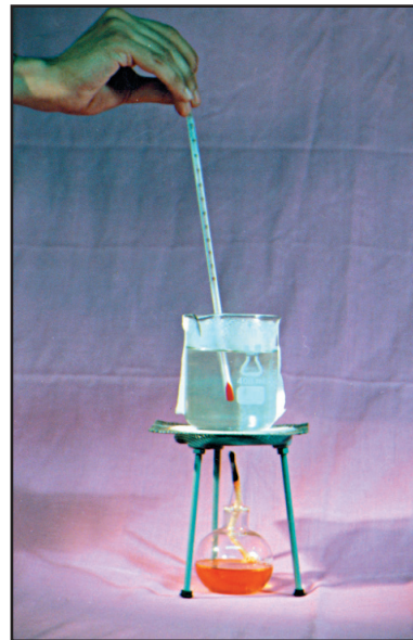
شکل (۱-۳۰) اندازه گیری نقطه غلیان آب
