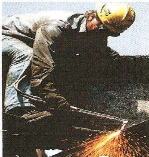
شکل (7-14): چراغ اکسی استیلین در موقع سوختن حرارت زیاد را تولید می‌کند که در ولدنگ کاری و قطع فلزات به کار میرود
