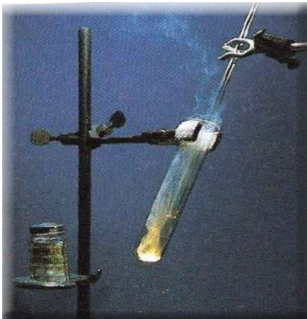
شکل (3-6) تعامل گاز کلورین با سودیم.
