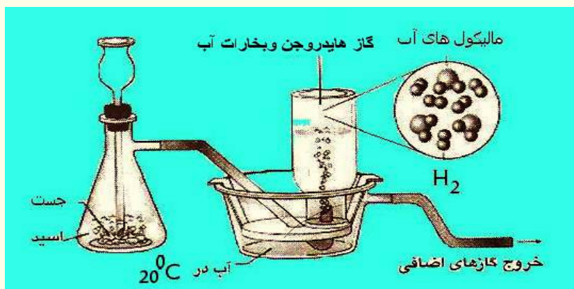
شکل (7-4): تعامل جست با تیزاب نمک (HCl)
